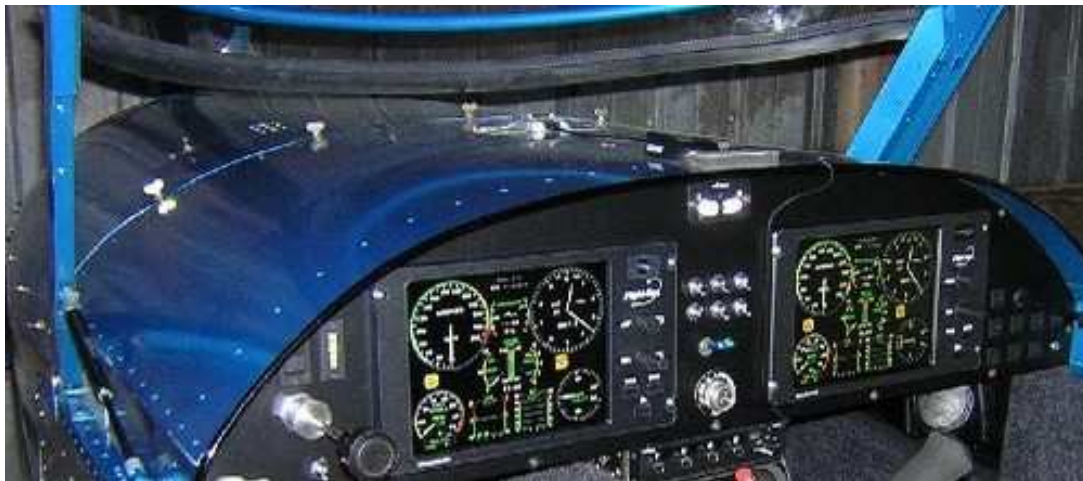
Flight Box monté sur un ULM Zenair 601
